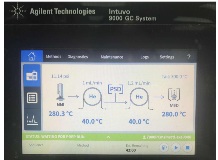
图 2. Intuvo 9000 自动配置流路
