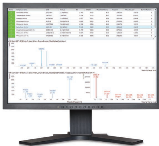
使用 PCDL 作为起点来构建常规分析，利用 MassHunter 定量分析软件进入高通量经典目标物筛查（左图）或目标物和疑似物筛查（右图）
