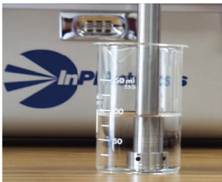
图9 EIC实验室设计的便携式表面增强拉曼光谱仪检测水样
