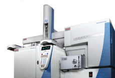
TSQ Quantum XLS Ultra GC-MS/MS LC 和 GC 三重四极杆质谱仪家族中的高灵敏度、高选择性系统
