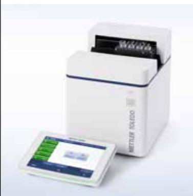
配上灵活的附件和自动化装置，就可根据您的需求度身定制仪器，满足个性化的应用需求。易于拿取的敞开式样品区域可快速方便地装卸比色皿，并且不会影响到仪器的紧凑布局。
