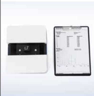
超越系列紫外可见分光光度计有着精致的小巧外观。FastTrack™紫外可见分光光度计技术极大压缩了光学部件的布局，同时又不降低其性能。此外，它可以独立操作，不需要连接电脑，因而节省了大量台面空间。
