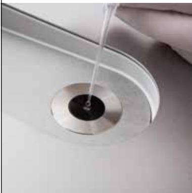
在需要测量小样品量或高吸光度样品时，超微量紫外可见分光光度计测量是方法之选。只需1μL样品就能进行可靠的测量。用移液器将纯样品滴至测量台，测量臂自动锁定至精确设定的光程。因为不用稀释样品，所以避免了测量误差。
