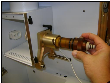
图3 自动锁扣式样品引入系统
