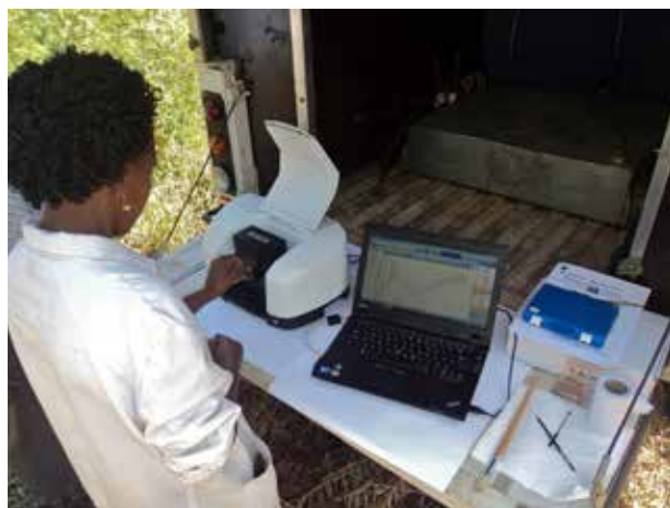
图：使用PerkinElmer带有漫反射附件的Spectrum Two FT-IR 光谱仪在汽车上对肯尼亚西部区域土壤进行测量
