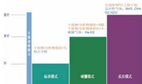
NexION 300 ICP-MS 三种测量模式及其去干扰水平
