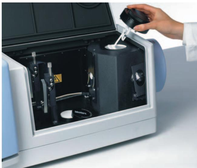
软件控制的可变角度的通用反射附件(URA)
