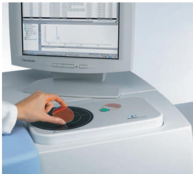
PerkinElmer公司的变角定向反射附件是基于欧盟资助的 THERMES项目的推荐, 开发并商品化的一种配套工具, 它为先进的镀膜玻璃产品的发射率测量方法按照 EN673和EN12898提供了一套完整的解决方案。这套工具的所有光学元件都由密封罩保护而不会受到损坏和污染。同时还提供一套测量与标定的参照标准以保证可追溯到国际标准。还包括计算软件。
