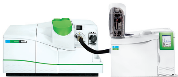
通过GC输送线将Clarus 580 GC（右）与NexION 300D ICP-MS（左）相联接
