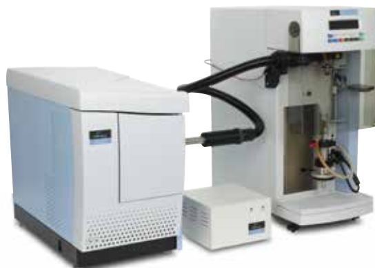
图2. Pyris 1 TGA 热重分析仪和Clarus MS由TL 2000传输线连接
