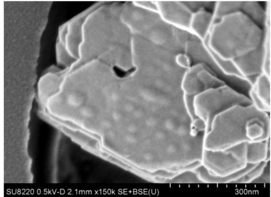
高岭土是一种化学结构为 $\text{Al}_2\text{Si}_2\text{O}_5(\text{OH})_4$ 的矿物质粘土及岩石，它富含在高岭石中，即我们已知的高岭土或者陶土，并且被用作铜版纸的涂层颜料。由于它的品质取决于颗粒的大小或者分布，因此用SEM观察是很重要的，但因样品容易受到电子束损伤而较难达到高放大倍率。
