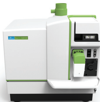
NexION® 2000 电感耦合等离子体质谱仪
