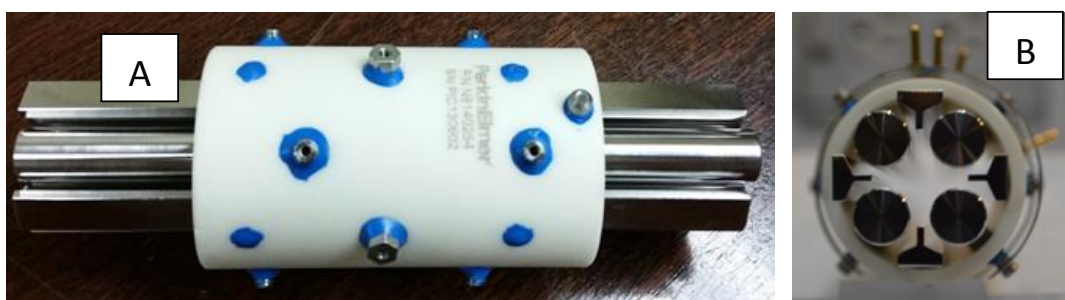
轴向加速四极杆通用池:(A:正面图;B:侧视图)
