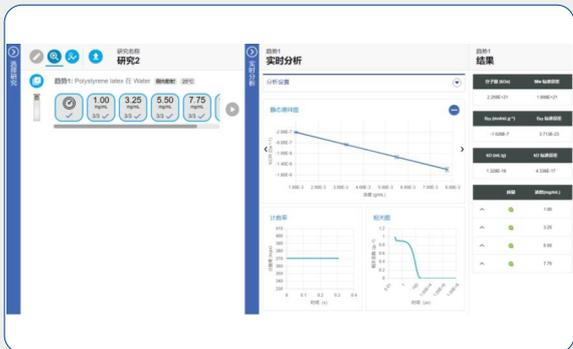
NS-90Z Plus静态光散射德拜图法分析纳米粒子分子量
