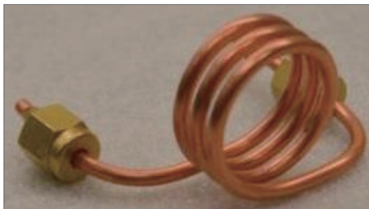
图 3. 大部分 ICP 源中使用的铜加感线圈。
