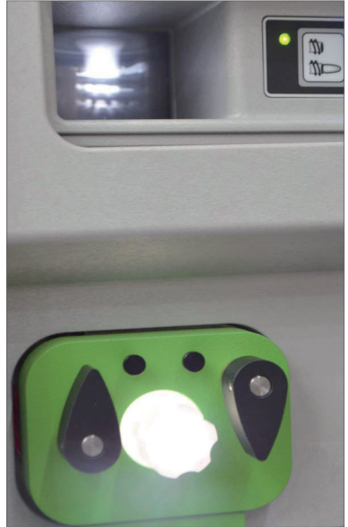
图 8. NexION 2000 的进样系统拆除，中心管暴露在空气中，等离子体依旧稳定
