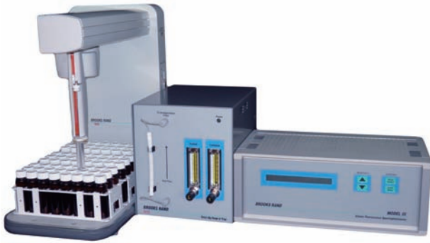
MERX 全自动总汞分析系统(EPA 1631 方法)
