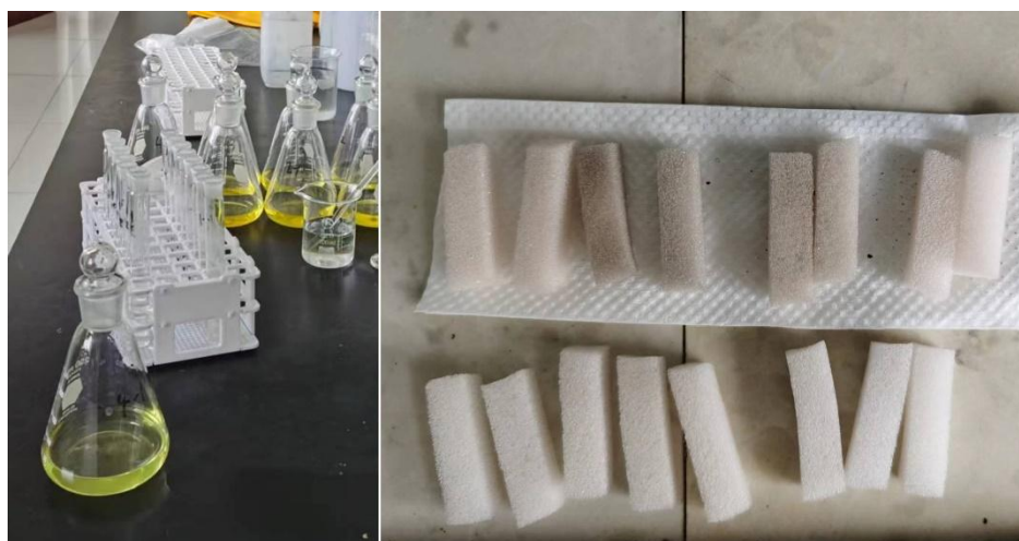
左图：装有样本水样的锥形瓶，右图：用于吸附的泡沫
