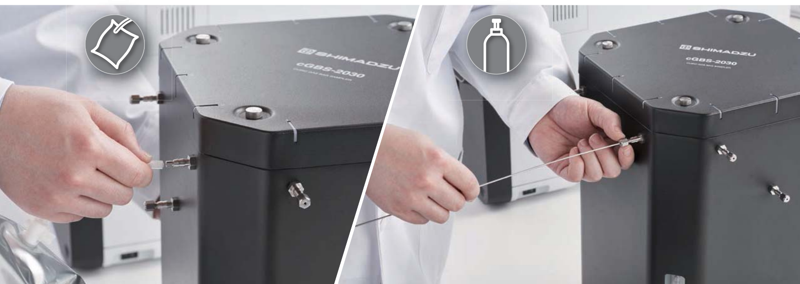
气袋吸入进样法 通过软管直接连接气袋
