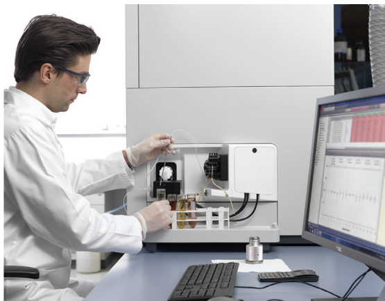
图1. 最为方便、简洁的操作设计、最短管路减小记忆效应、最快的完成样品分析的iCAP Q ICPMS进样系统。
