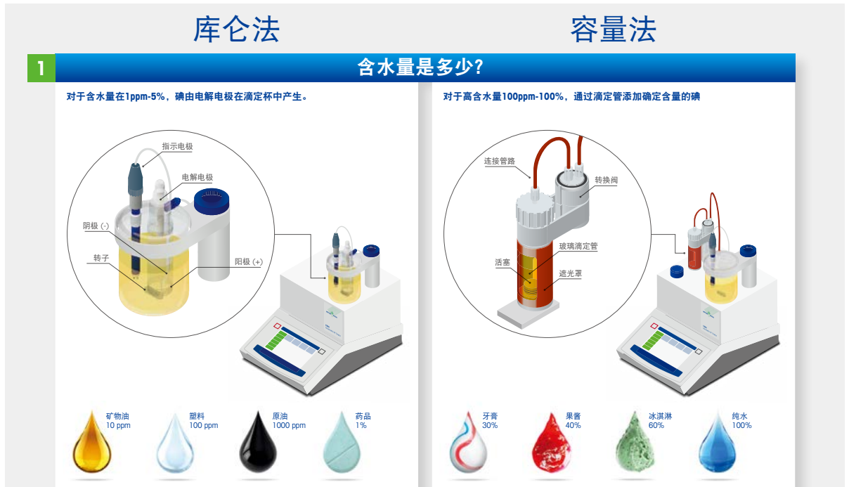
图2A：库仑法(左图)和容量法(右图)水分仪。典型样品标注在下方
