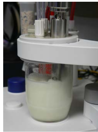
图6B/6C：均质器在容量法KF的滴定杯中，均质前(左图，B)和均质中(右图，C)。
