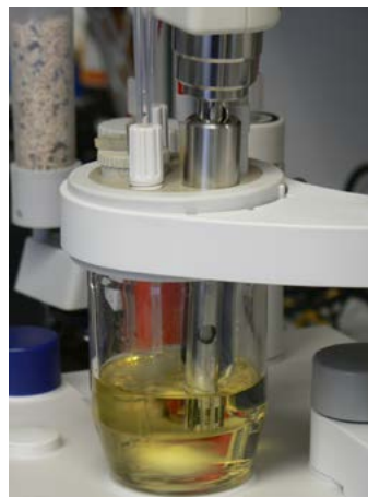
图6B/6C：均质器在容量法KF的滴定杯中，均质前(左图，B)和均质中(右图，C)。
