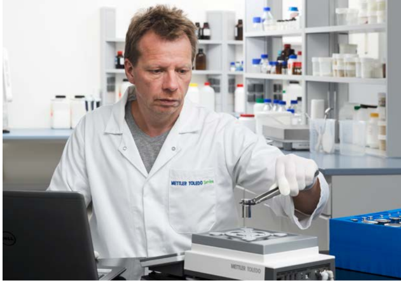
图 19: 需使用经认证的砝码定期执行校准，以确保准确称量
