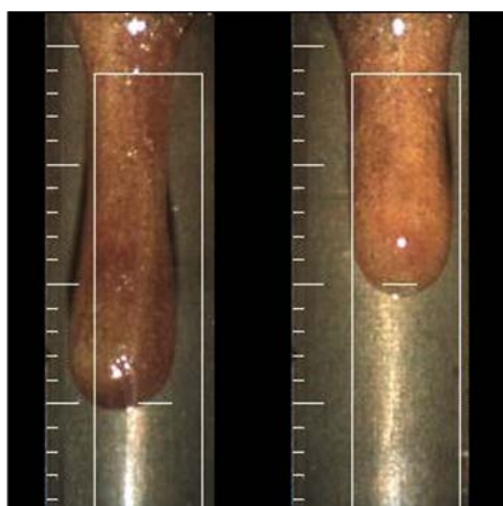
图 59: 超越系列滴点系统可对两个样品进行全自动同时分析
