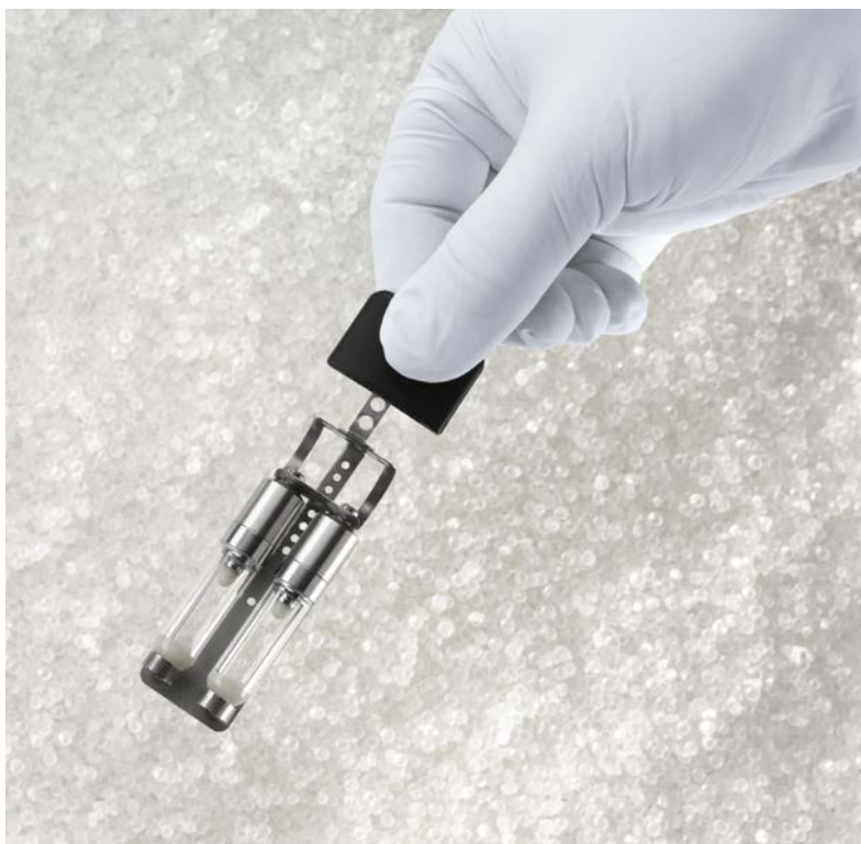
图 58: 超越系列滴点系统可对两个样品进行全自动同时分析
