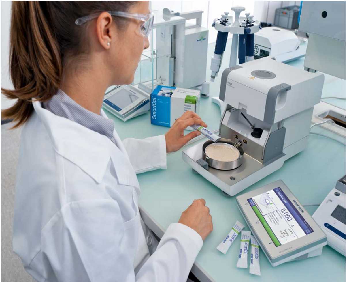
图 24: SmartCal 是一种独特的测试物质, 可验证快速水份测定仪的性能
