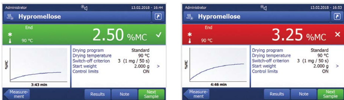
图 20: 绿色和红色显示色分别表示结果是否在定义的允差范围内
