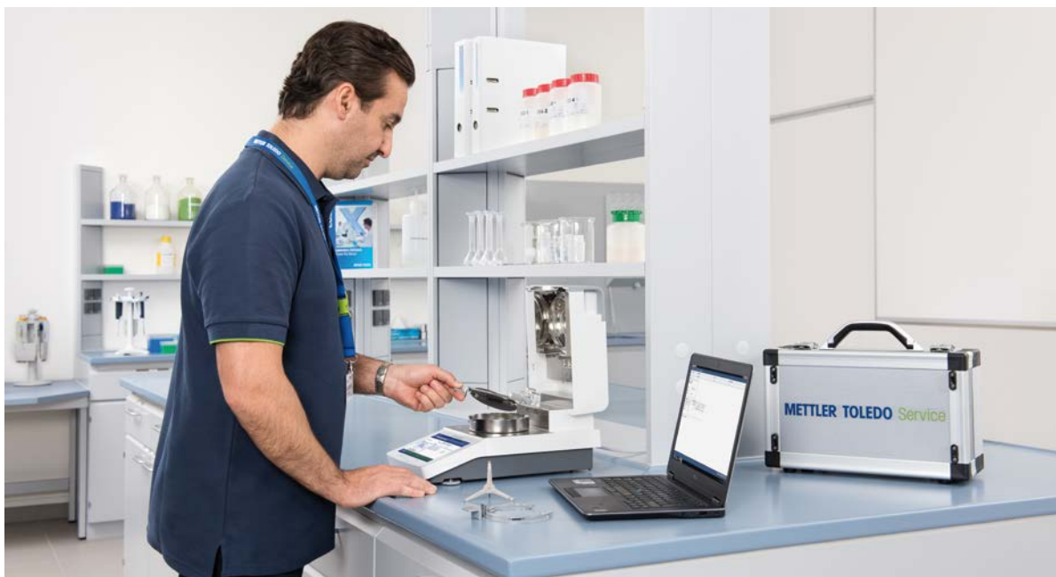
图 23: 应校准快速水份测试仪的加热单元和称量单元
