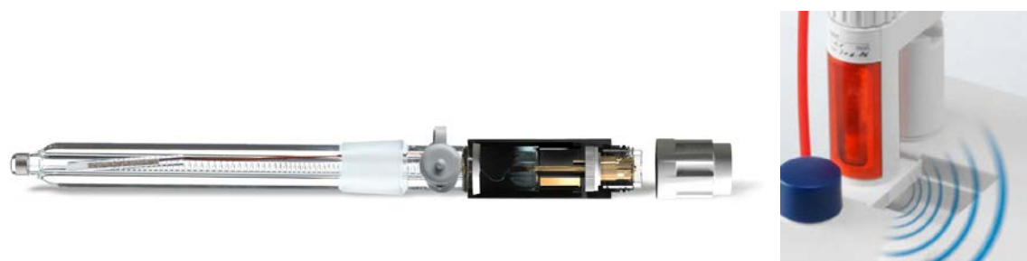
图 36: 即插即用电极 (左) 和滴定管 (右) 自动将滴定剂和电极的相关信息传输至滴定仪
