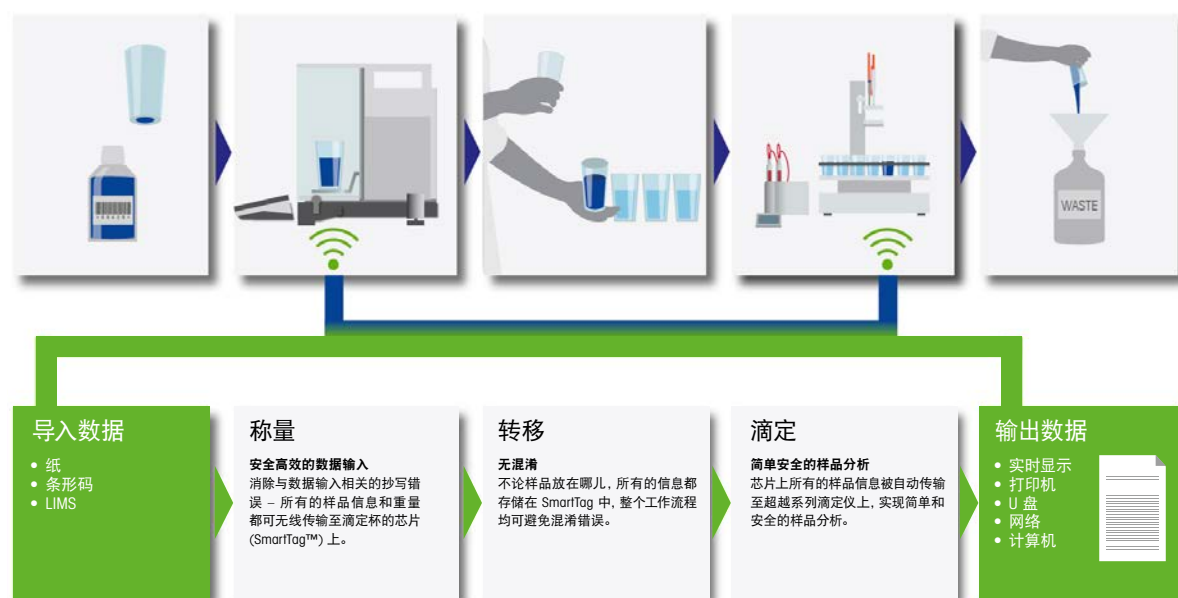
图 38: SmartSample 可通过消除称量过程中的抄录和排序错误来提高效率
