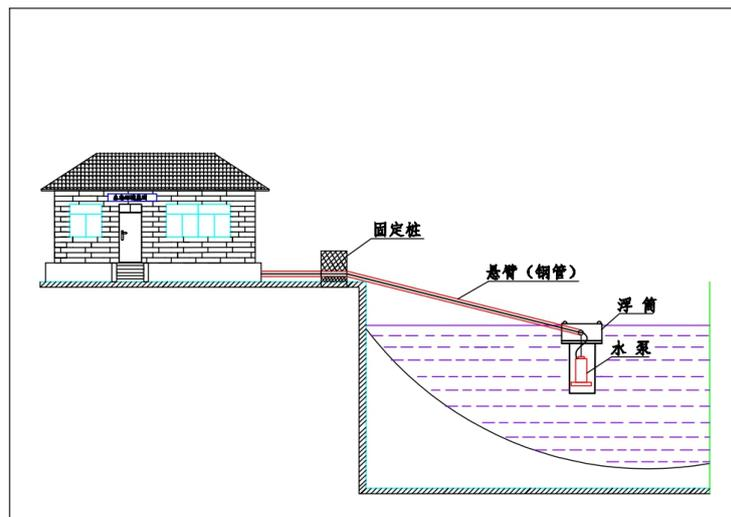
图A.3 悬臂式采水参考示意图
