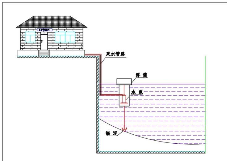
图A.2 浮筒式采水参考示意图
