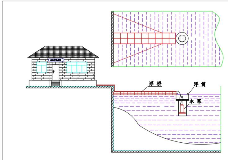
图A.4 浮桥式采水参考示意图
