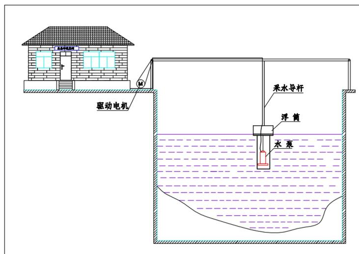
图A.5 拉索式采水参考示意图
