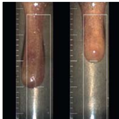
松香软化点测定。样品周围白色边框指示评估区，底部的白线显示当前检测边界。标尺单位mm
