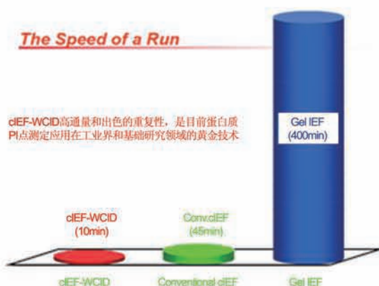
图一：cIEF-WCID (红色)、传统单点检测毛细管电泳 (cIEF, 绿色) 和凝胶介质等电聚焦 (Gel IEF, 蓝色) 的分析时间比较
