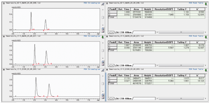
图 4 分离条件的评估和基于最优条件的手性分离色谱图 Evaluation of Separation Parameters and Chiral Separation Chromatogram Using Optimized Parameters
