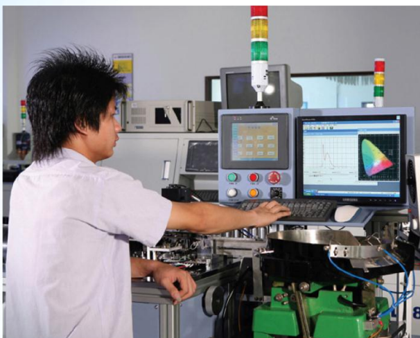
图 1. 微型光谱仪在 LED 分拣工艺中表现良好,该工艺中迅速采集数据和准确测量至关重要。
