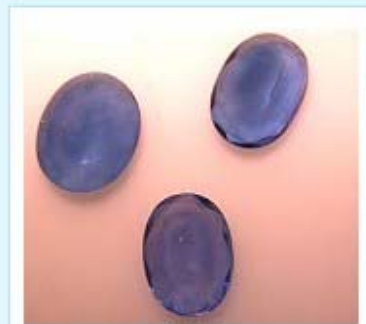
(圖六) 擴散處理藍寶石浸入二碘甲烷中腰部顏色加深
