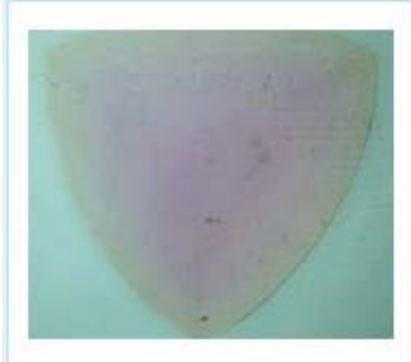
(圖三) 經深度擴散處理橘黃色藍寶石浸在二碘甲烷液中內部呈粉紅色
