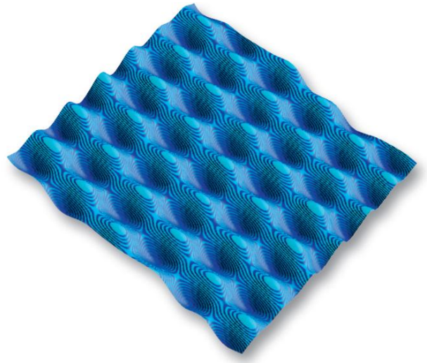
利用 Innova 获得 HOPG 的原子像. 图中 STM 图像的扫描范围 1.3 nm.
