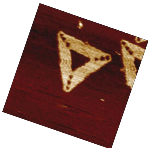
闭环扫描模式下在云母基座上观察溶液中的 DNA 自组装三角形结构。图像尺寸 250nm。从该图像中可以清晰获取组装结构的细节信息。(样品由 P. Rothmund, Caltech 提供)
