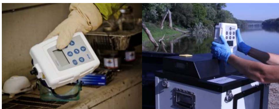
图一：Griffin X-Sorber 手持气体取样器样品收集过程（左）；X-Sorber 放置于 Griffin 460 GC/MS 上样品解
