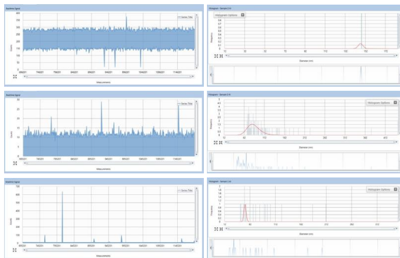
图3. 未知样品中Al在不同稀释度下的实时信号和纳米颗粒粒径直方图。
