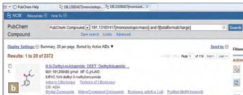
图4 a和b 未知分析化合物的精确质量和同位素比值被输入AxION EC ID软件, 进行元素组成的测定。采用PubChem数据库检索, 以降序AIDs (大量化合物编号) 编号排序, 给定元素组成的第一可能的候选化合物为N,N-二乙基-m-甲苯酰胺 (DEET), 是杀虫剂的常规成分。
