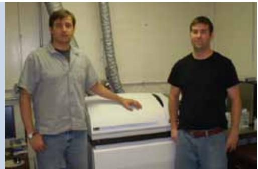
通常来说，ICP-MS的主要吸引力在于它的检出限一般要比ICP-OES低1000倍，比石墨炉原子吸收要低10-100倍。因此，ICP-MS测定的大部分样品都是在测定样品中非常低浓度的待测元素。ICP-MS能够在10分钟时间内对一个样品的22种元素进行3次测定，对于许多分析人员来说，这个速度已经很令人满意了，特别是以前使用2种或多种分析方法测定这些元素的人。但是，如果你问一个大型的协同合作实验室，比如Superfund Analytical Services下环境分析实验室，你得到的答案可能会是“还能再快吗”。
