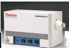
型号STF55346C, 三区控温管式炉配3个可编程温度控制器分别控制3个炉区
