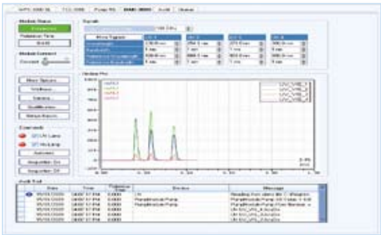
通过直观的ePanel可直接访问所有仪器并进行控制（例如流速、温度、检测波长），操作便捷。
