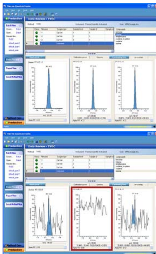
图4 A: 样品中甲苯的离子比例确认; B: 样品中邻二甲苯的离子比例确认
