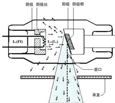
图 1 X 射线管出射谱示意图
