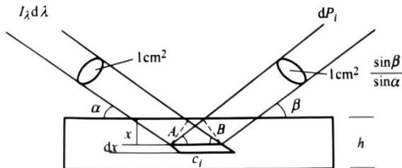
图 3 一次荧光强度推导过程中的物理和几何示意图
