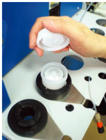
SNAP 色谱柱盖回转 90 度， 打开
