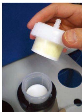
将上样杯安装到色谱柱
