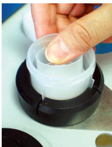
向一侧压，取出导流器
