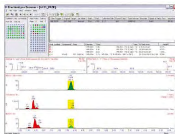
FractionLynx浏览器显示相关样品和组分信息。如有必要，可互动编辑软件得出的结果
