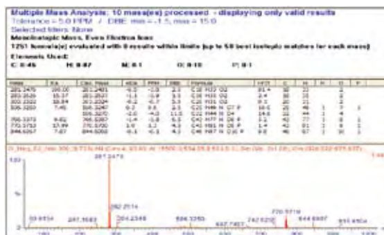
图5 保留时间9.71分钟, 质荷比为844.608的组分经MSE产生的碎片离子元素组成分析报告。化合物是含有聚苯乙烯的脂肪酸盐和山嵛酸酰基链。
