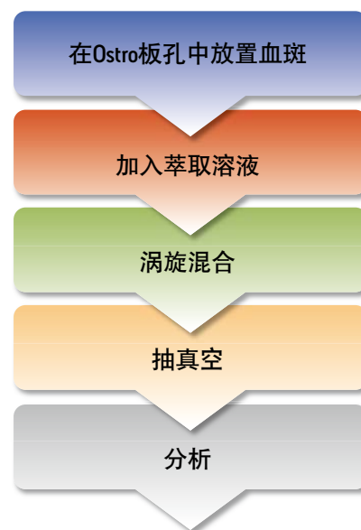
图2. 采用Ostro 96孔板的干血斑萃取流程。
