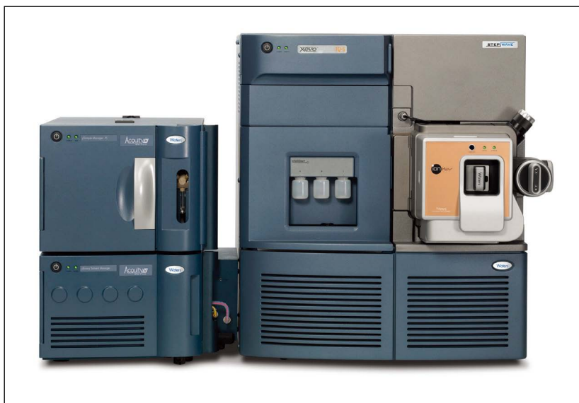
图1. ionKey/MS系统：由Xevo TQ-S、ACQUITY UPLC M-Class、ionKey源和iKey分离装置构成。
