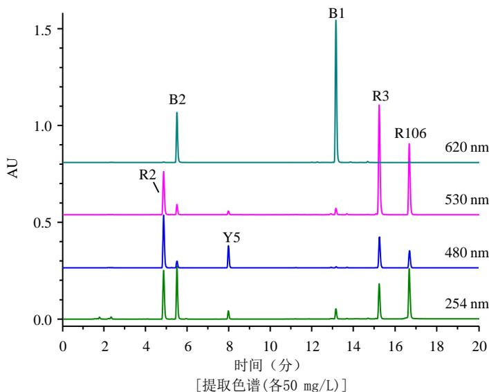
本次所分析的六种人工合成色素具有不同的最大紫外线(UV)吸收波长。因此DAD可用于分析和获得在最佳波长下各种人工色素的提取色谱图。使用DAD可以对具有不同最佳波长的组分进行同时分析。
