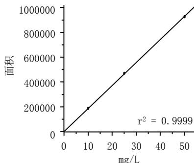
所有标准曲线(所有组分的浓度范围为0.5~50 mg/L)均显示了 $r^2 \geq 0.999$ 良好的线性相关关系
