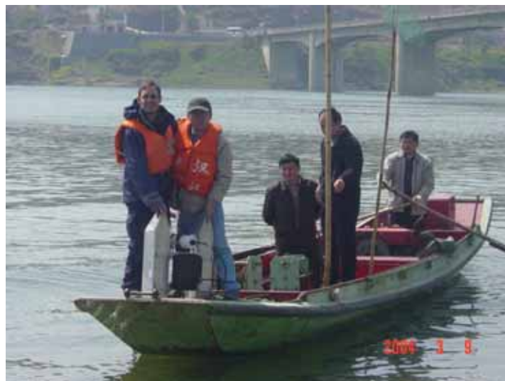
图 3 用于汉江黄家港水文站比测的 SonTek 1.5MHz ADP “河猫”
