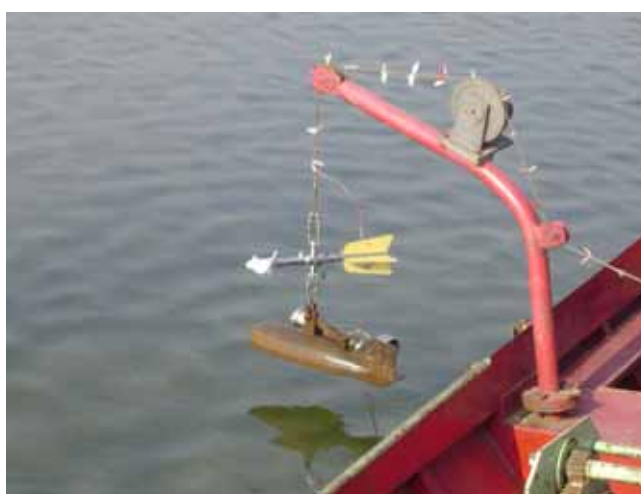
图 4 用于汉江比测的机械旋桨式流速仪和铅鱼
