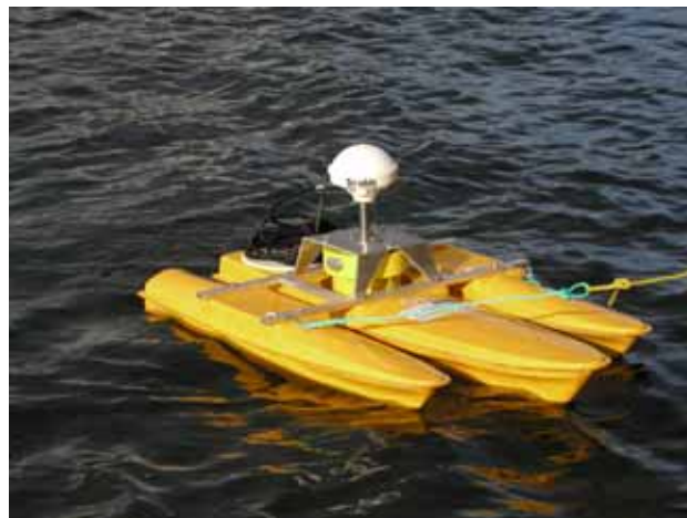
图 2 采用光纤玻璃钢三体船的“河猫”
