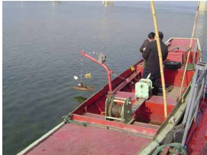
图 5 用于汉江黄家港水文站比测的机械旋桨式流速仪测流装置
