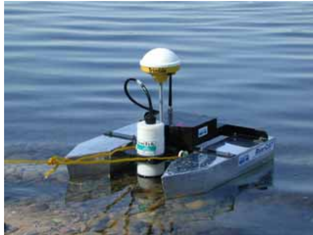
图 1 在汉江比测的 1.5MHz ADP “河猫”
