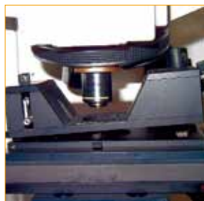
用于超高空间分辨研究的 Nanonics AFM/NSOM
