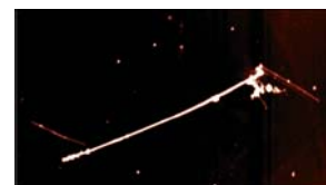
纳米线的AFM形貌成像
