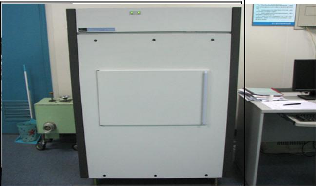
美国Perkin-Elmer公司Quantulu-1220-003超低本底液体闪烁谱仪 Ultra low level liquid scintillation spectrometer, for 3H, 14C analysis)
